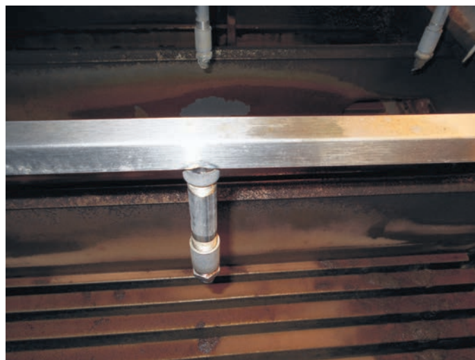
Pannes à plis d'un évaporateur avant et après lavage avec une solution d'acide acétique à une concentration de 3,9 %.
