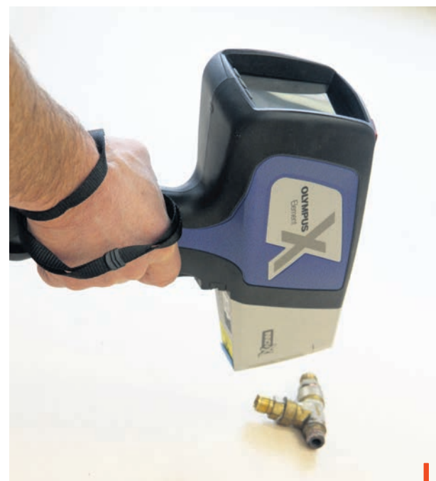
Pistolet à fluorescence rayon X utilisé par le Centre ACER afin de permettre l'estimation de la teneur en plomb de l'équipement acéricole.
