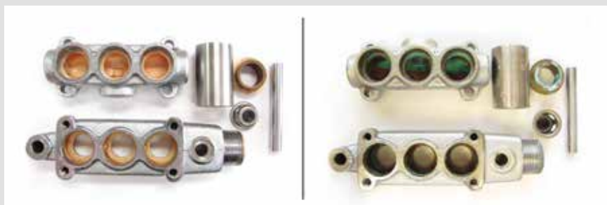
Figure 4 : Exemple de pièce avant et après le test en chambre de brumisation
