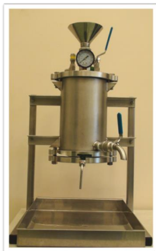
Figure 3 : Unité de filtration à l'échelle pilote utilisée pour la production du sirop d'érable
