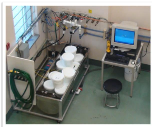
Figure 1. Système de décongélation à l'échelle pilote
