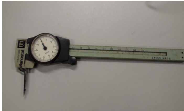
Figure 1. Pied à coulisse gradué au millimètre et adapté à la mesure de la fermeture des entailles
